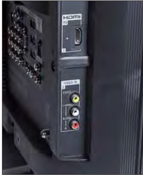
Figura 12. Esta interfaz posee una sola forma de conectarse (tiene una conexión a presión idéntica al USB) y no es parecida a ningún otro tipo de conector de señal de video o sonido.
