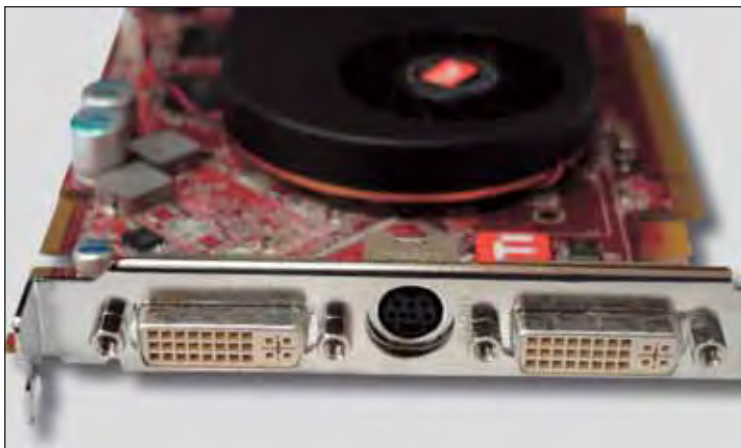
Figura 8. Las placas gráficas con salida S-Video son muy habituales, e incluso las onboard tienen muy buenas opciones de calidad y configuración para ver la imagen en el televisor, en distintas normas o sistemas de televisión.
