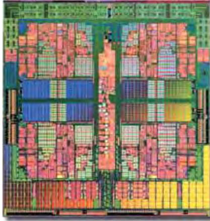
Figura 15. Esta imagen es una radiografía de un procesador de 4 núcleos. En él hay más de 450 millones de transistores.
