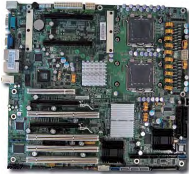
Figura 14. Este motherboard posee unos zócalos especiales para conectar hasta 64 GB de memoria de forma más ordenada.
