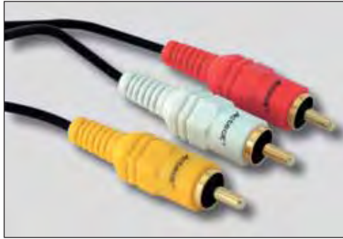
Figura 7. Una de las opciones más comunes es utilizar cables del tipo RCA. En el estándar, la ficha de video es la amarilla y las otras dos corresponden a los dos canales de audio.
